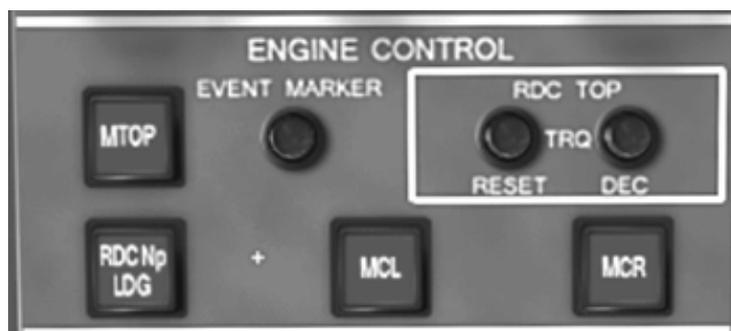
Figura 15.3.2.1. Panel de control de los motores
