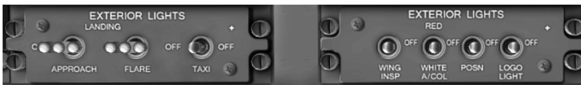
Figura 14.1.1. Paneles de control de la iluminación exterior
