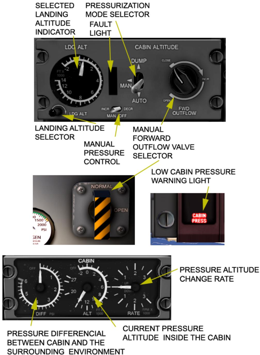
Figura 4.1.2. Controles e indicadores de la presión del aire
