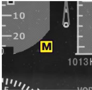
Figura 16.3.1. Indicador de radiobaliza
