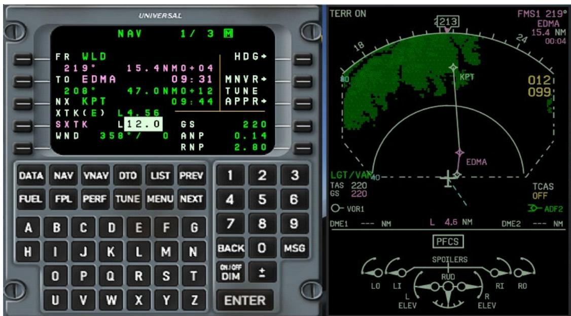
Figura 16.9.8.7. Ilustración del modo SXTK
