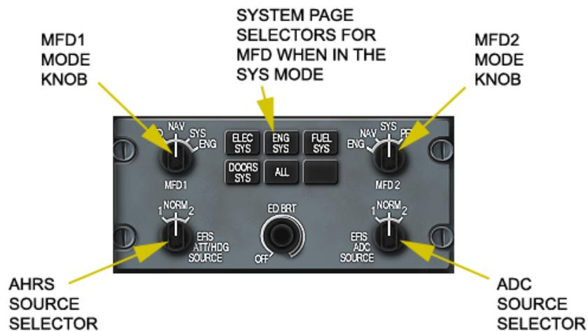
Figura 12.1.2. Panel de control del sistema integrado y de motores
