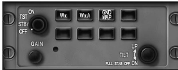
Figura 16.8.1. Panel de control del radar meteorológico
