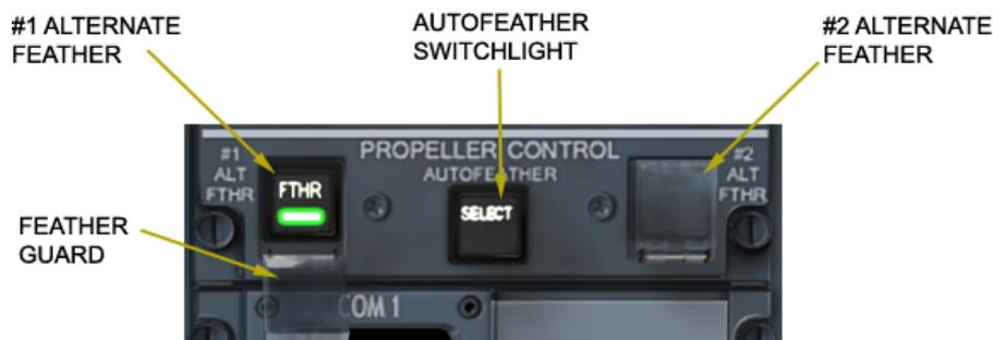
Figura 15.3.4.1. Panel de control de las hélices
