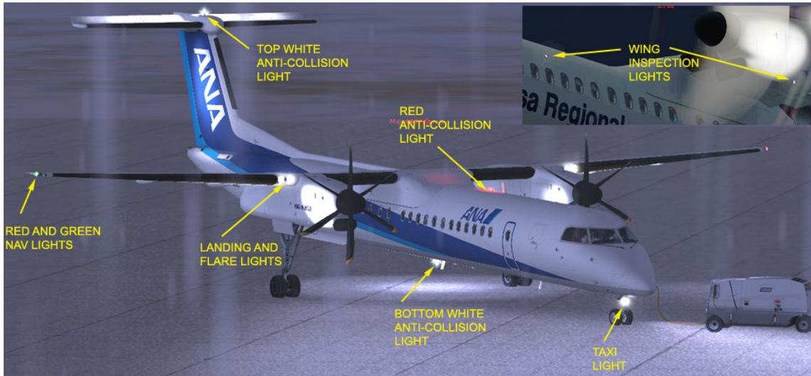
Figura14.1.2. Luces exteriores
