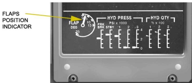
Figura 8.2. Indicador de la posición de los Flaps
