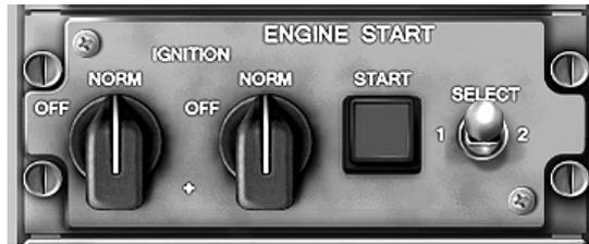
Figura 15.3.3.1. Panel de arranque de motores
