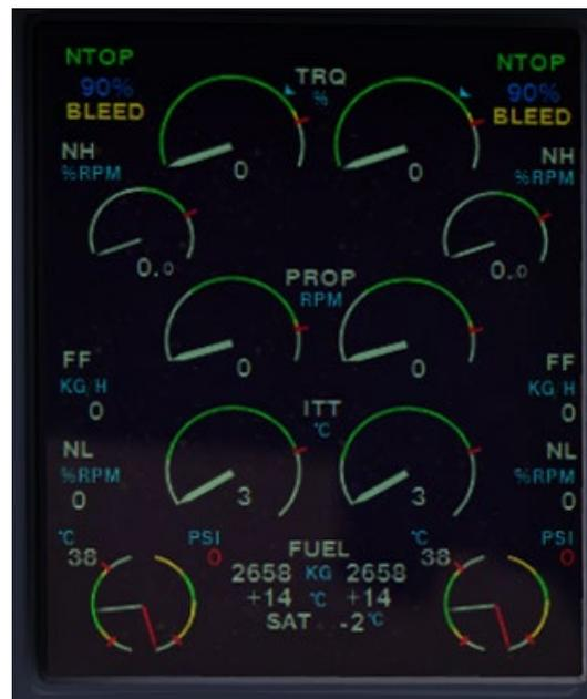
Figura 12.4.1. Pantalla de motores (ED)
