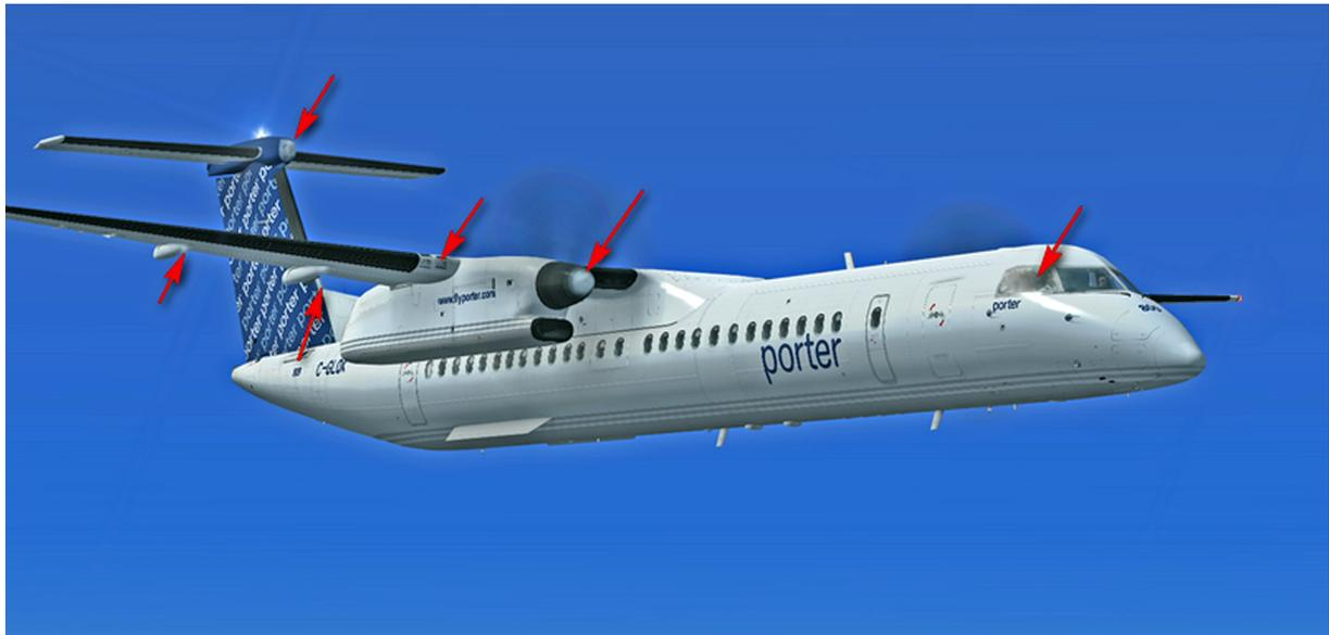
Wenn Sie sich das Flugzeug im Flug von außen betrachten, können Sie sehen, dass selbst, wenn die Antieisanlage eingeschaltet ist, einige Teile nicht eisfrei sind. Nämlich z.B. die Spitzen der Propeller und die Seitenscheibe des 1. Offiziers.
