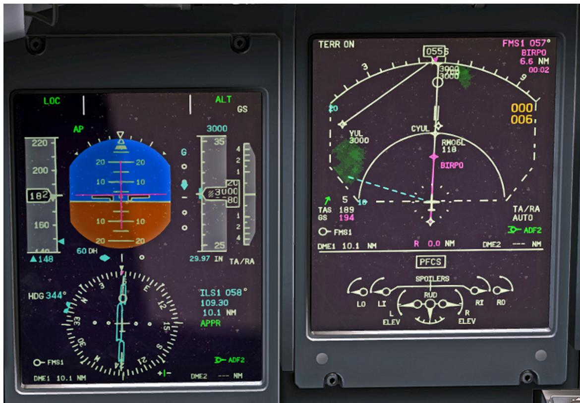
Beim Auskoppeln des VNAV setzen wir VS und ALT SEL, um die laufende vertikale Geschwindigkeit zu behalten und folgen, bis wir 3.000 Fuss erreicht haben. Das HDG stellen wir auf den anliegenden Kurs und drücken das HDG um den HDG SEL Modus einzuschalten.
