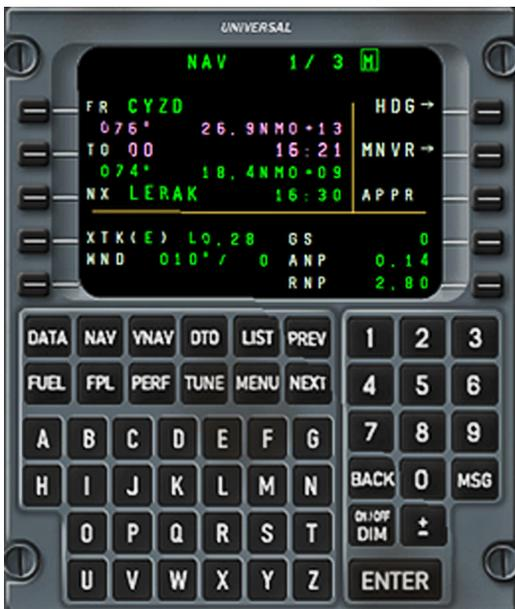
Nun klicken Sie auf die NAV Taste. Es wird die Navigationsseite angezeigt. Stellen Sie sicher, dass die FROM (FR) und TO richtig dargestellt werden. FR muss der Abflughafen sein und bei TO muss der erste Wegpunkt des Flugplanes stehen.
