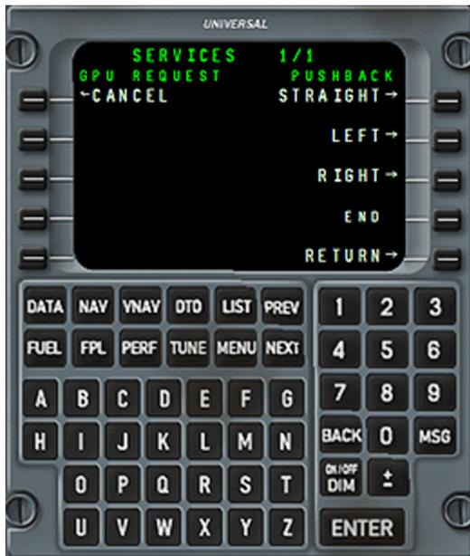
Sie sehen auf der rechten Seite die Tasten LSK6 - LSK9. Diese sind für das Pushback Verfahren vorgesehen. Fordern Sie mit Klicken auf LSK6 (STRAIGHT) das Pushback Verfahren an und es wird beginnen. Sie hören einen Dialog zwischen dem Flugkapitän und der Ground Crew.
