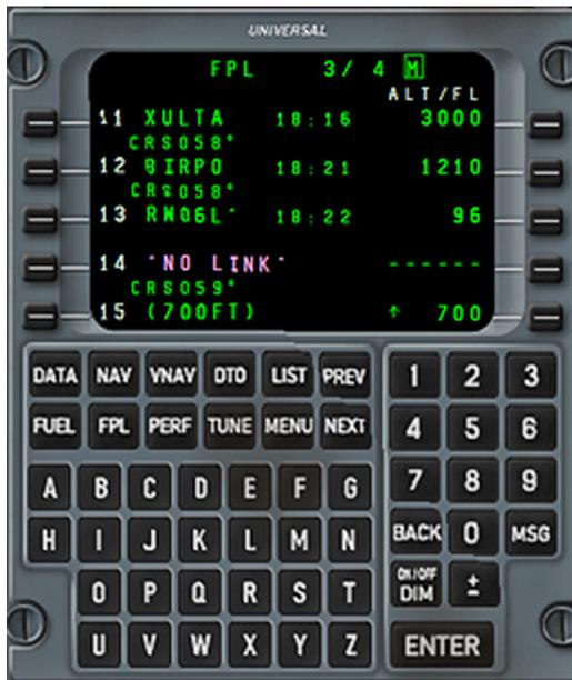
Der NO LINK-Eintrag nach dem Eintrag RWY06L (# 14) sollte nicht gelöscht werden. Das FMS löscht ihn automatisch, wenn wir einen „MISSED APPROACH“ Anflug durchführen (Fehlflugverfahren). Sie können auch sehen, dass der XULTA Wegpunkt zweimal aufgeführt ist. Einmal vor und einmal nach dem Eintrag „I06L“. Dieses Arrangement, auch als „Sandwich“ bezeichnet, muss immer überprüft werden, denn es muss vorhanden sein.
