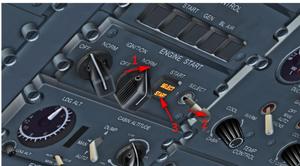
Um den Motor # 2 zu starten, drehen Sie den IGNITION Schalter nach rechts (1), stellen den ENGINE Schalter auf # 2 (2) und drücken auf START (3).
