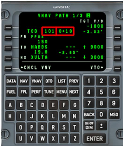
In diesem Modus errechnet das FMS den TOP OF DESCEND (TOD) Punkt. Das ist der Punkt, ab dem Sie sinken müssen. Die VNAV Seite zeigt die Distanz zum TOD und die geschätzte Zeit, an dem Sie diesen Punkt erreichen.
